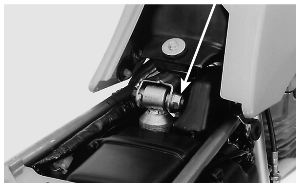
AMORTECEDOR BUCHA/BORRACHA PARAFUSO/PORCA DE FIXAÇÃO SUPERIOR
